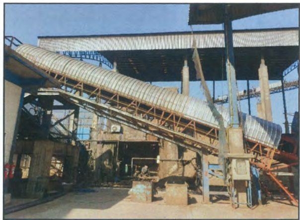
รูปที่ 41 หลังคาปิดคลุมระบบสายพานลำเลียงเชื้อเพลิง
