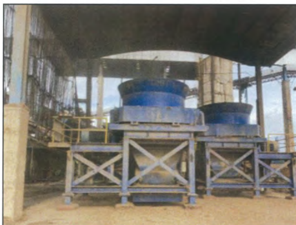
รูปที่ 61 อาคารป้อน-ผสมเชื้อเพลิงที่มี หลังคาปิดคลุมและมีวัสดุครอบปิด แหล่งกำเนิดเสียง
