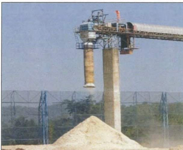
รูปที่ 38 Chute ป้องกันการฟุ้งกระจาย ของฝุ่นกากอ้อย
