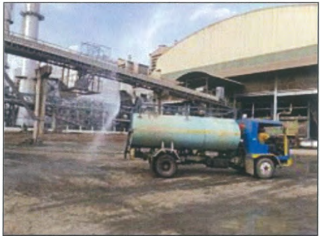
รูปที่ 50 การฉีดพรมน้ำเส้นทางลำเลียงถ่าน
